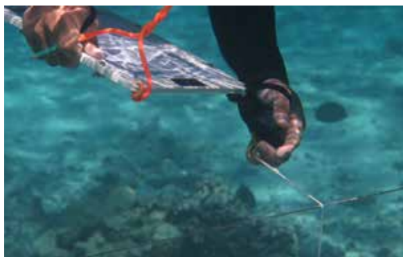
Méthode du PIT avec fil de plomb ©Criobe
